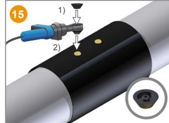
15) 1) **Placer** à l'aide d'un outil adapté le 1<sup>er</sup> bouchon de fermeture à souder le socle de la machine à souder pour le **chauffer**.
