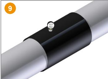
9) **Percer** un 1<sup>er</sup> trou dans la manchette à l'aide d'une perceuse en veillant à **ne pas percer sur la soudure de la coupe longitudinale**.
