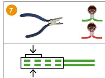
1) **Introduire** les fils conducteurs dans le connecteur (cosse) jusqu'à arrivée en butée.
