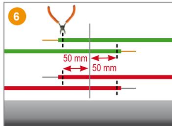
Après l'opération 5, **recouper** les fils. **Couper** les fils de façon à obtenir une surlongueur de 50 mm, et de sorte que les extrémités coupées puissent être introduites en toute facilité dans les connecteurs.
