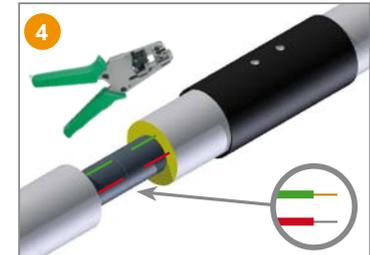
**Dénuder** les fils afin de réaliser le contrôle des branchements.
