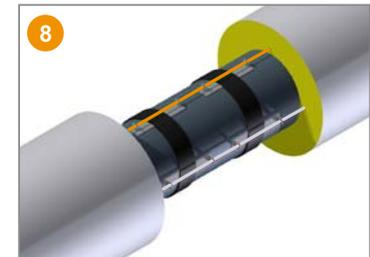
1) Procéder à un test de traction manuel des fils conducteurs connectés.
