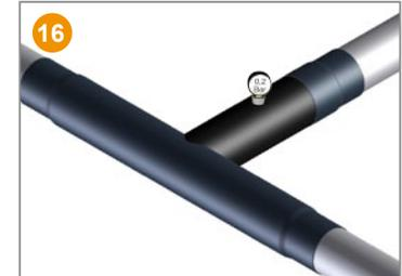
⚠ **Il est recommandé d'effectuer un test d'étanchéité à l'air à 0.2 bar** avec une pompe manuelle et un manomètre. Si cela n'est pas possible, effectuer un contrôle visuel. Il est impératif de laisser refroidir à température ambiante avant de réaliser l'injection de la mousse polyuréthane.
